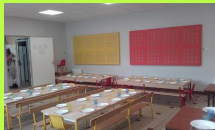
La salle de la cantine a été rénovée : un rafraîchissement des peintures et surtout la réfection du plafond et l'installation de panneaux acoustiques pour limiter la résonance du bruit et améliorer le confort lors du repas.
